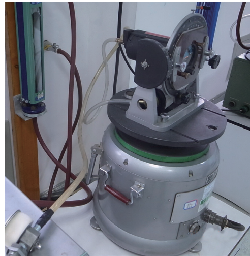
图2 真空系统空气流量与压力测试平台
