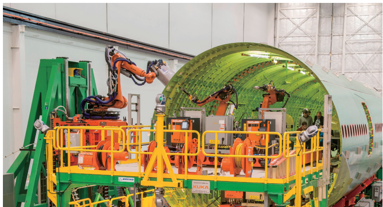
图3 FAUB系统下钻铆机器人工作场景
