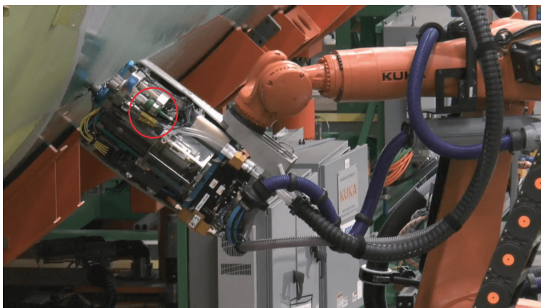
图4 备有智能点胶枪的KUKA钻铆机器人
