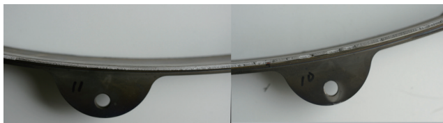
图3 贮箱焊缝爆破源断口
