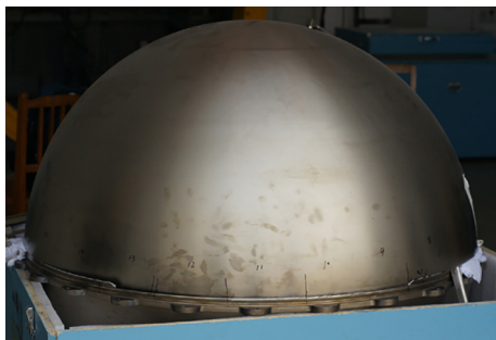
图2 贮箱焊缝爆破图
