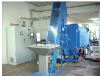
图2 气氛保护的连续水淬炉
