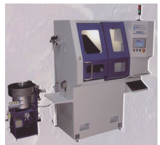
图6 圆角强化机 Fig.6 Radius rolling machine
