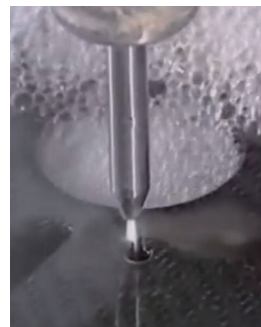
图3 高压水射流法加工复合材料构件 Fig.3 CMC-SiC composite components machined by waterjet
