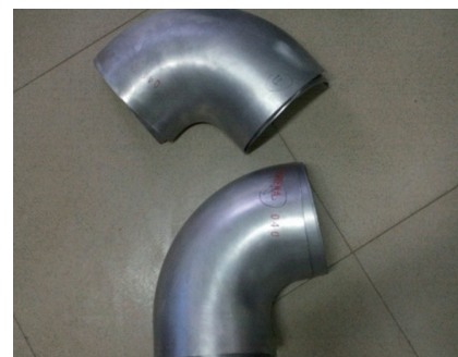
图7 半片拉深成形实际试验结果
