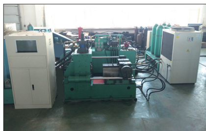
(a) 哈焊所研制的液压式LFW焊机
