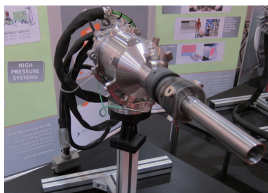
图3 高压冷喷涂枪体
