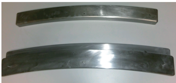
图13 实例零件外缘板成形模具 Fig.13 Outer flange forming die
