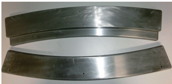
图12 实例零件内缘板成形模具 Fig.12 Inner flange forming die
