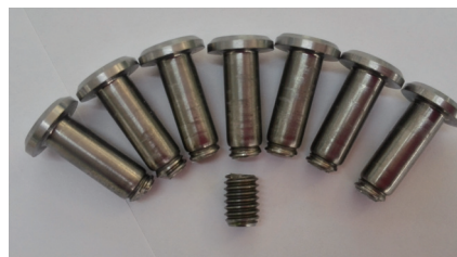
图6 Ti-5553抗拉型钛合金高锁螺栓抗拉失效照片
