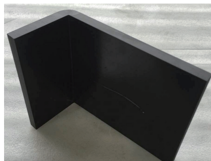
图2 回弹角测试中L型层板试验件
