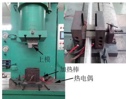
图12 试验装置和部分成形件
