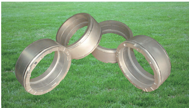
图4 某型号铝合金滑油箱HPVP-GTAW焊接构件
