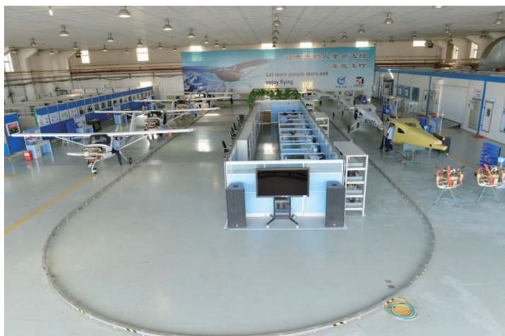
图3 脉动式生产线U型布局
