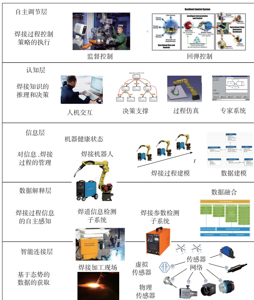
图5 CPSs 5C架构下的智能焊接系统
