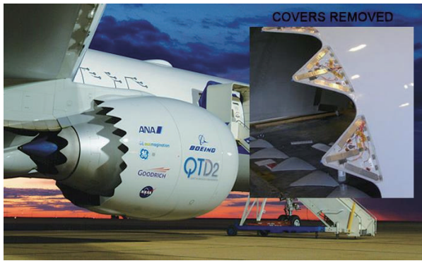
图13 可调节锯齿边缘喷嘴示意图
