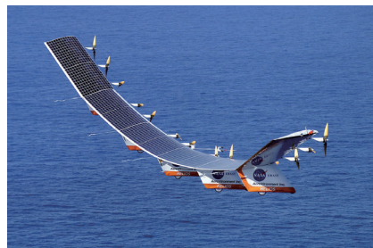
图7 “Helios”(太阳神)太阳能无人机大挠度气动弹性变形
