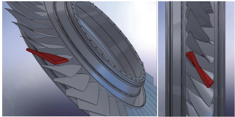
图4 旋转套料加工后的模拟叶型
