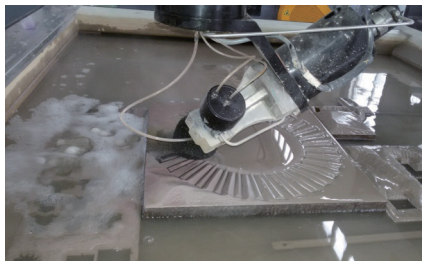
图6 整体叶盘试件水刀加工
