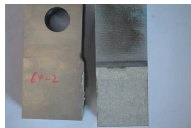
(c) 试件 2 断口形貌
