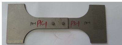
图9 干涉配合疲劳试验典型破坏模式—钉断
