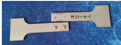
图6 干涉配合疲劳试验典型破坏模式—钉断
