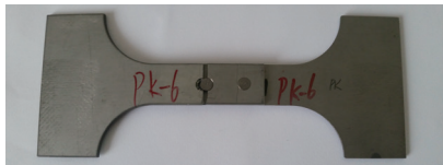
图8 普通铆接疲劳试验典型破坏模式—板断
