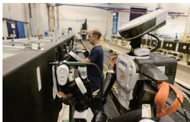
图11 FuturAssy双臂机器人在制孔 (空客公司)
