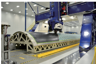
图2 自动铺丝技术在A350中机身蒙皮上的应用
