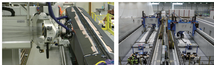
(a)空客 A350 采用旋转式工装 (b)波音 777X 采用固定式工装
