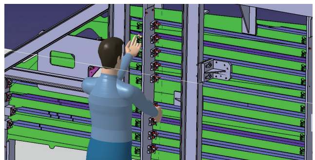
(b) 壁板与工装干涉检查
