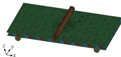
图9 网格划分后的有限元模型 Fig.9 Meshed finite element model
