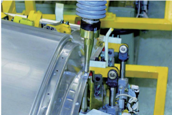
图11 机器人搅拌摩擦点焊在日本马自达汽车中的应用 Fig.11 Application of robotic FSSW in Mazda motor
