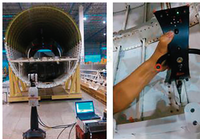
(a) 测量系统 (b) T-Probe 测量隐藏点
