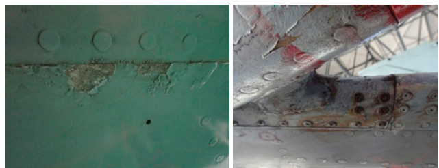
图1 海军飞机结构腐蚀损伤示例
