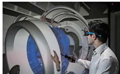
图1 基于VR技术的A330neo飞机短舱虚拟设计
