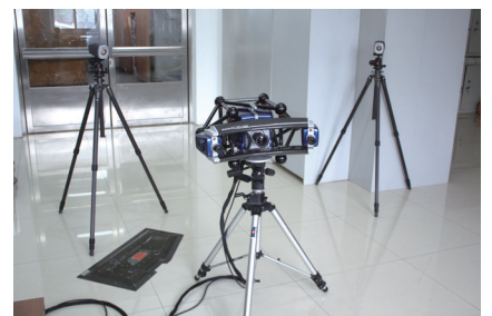
图5 Aicon扫描仪与笼形架标定
