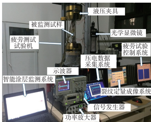
图7 压电传感器与智能涂层传感器融合损伤诊断系统
