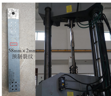
图2 试验件预制裂纹与试验情况
