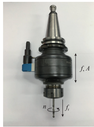
图2 振动刀柄复合运动示意图 Fig.2 Vibration tool handle compound motion diagram
