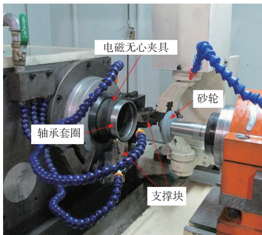
图1 轴承套圈磨削加工试验
