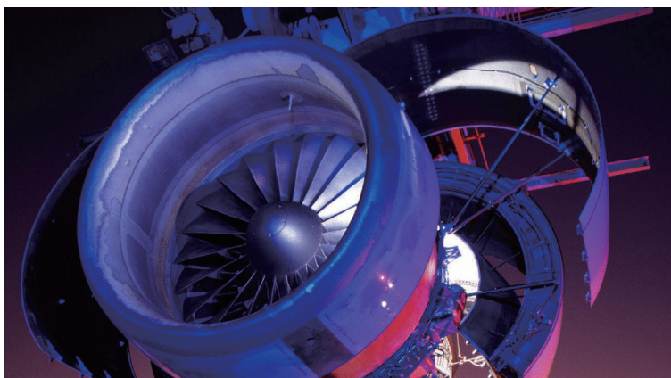
图2 应用于波音777飞机的PW4000-112发动机 Fig.2 PW4000-112 engine applied to Boeing 777 aircraft
