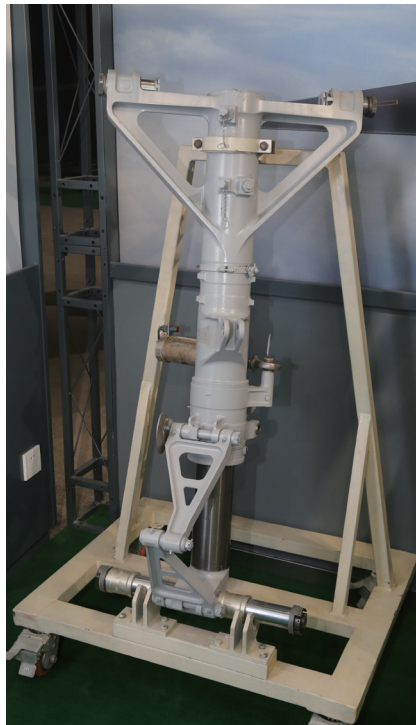
图3 A-100钢激光直接沉积成形增材制造飞机起落架
