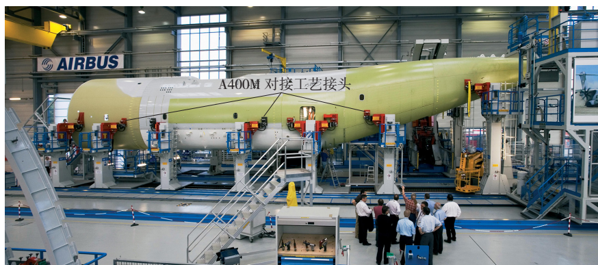
图9 采用工艺接头支撑的A400M机身自动化对接
