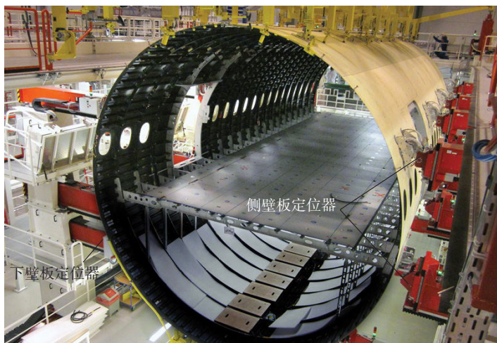
图2 采用自动化技术装配的A350机身段
