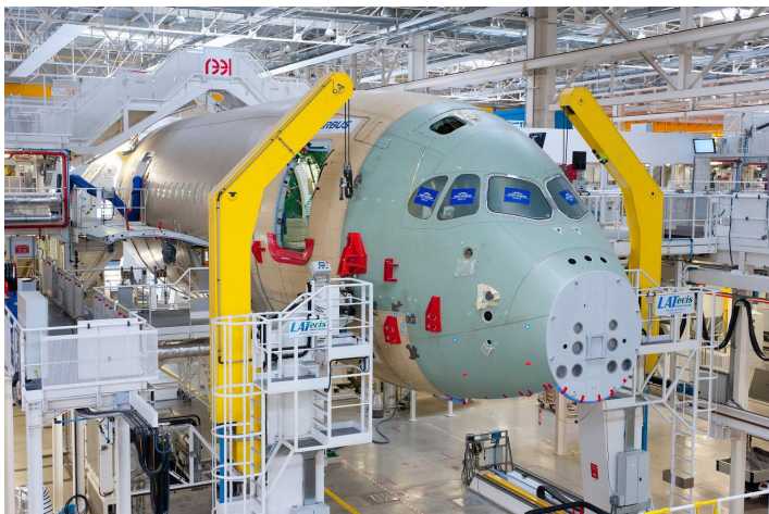
图1 采用自动化对接技术的A350大部件对接站位
