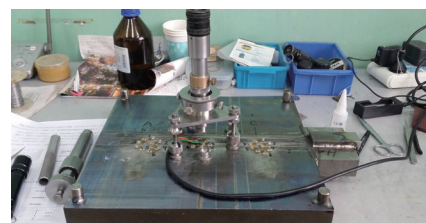
(c)半长试板热处理后焊接残余应力测量过程
