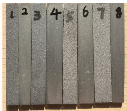
图 16 不同制件表面状态与粗糙度 Fig.16 Surface state and roughness of different parts
