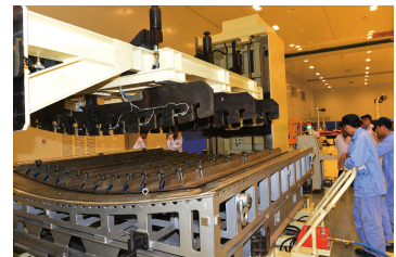
(h) 将长桁与零件成型模组合
