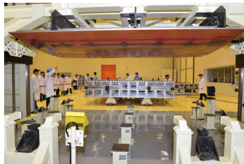
(c) 将夹持长桁提升,将长桁定位预组合模退出
