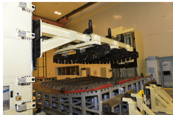
(a) 将长桁定位预组合模与翻转工装定位
