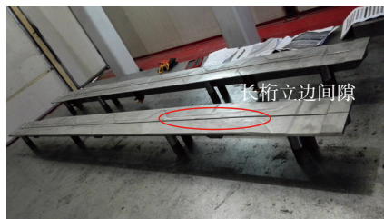
图17 长桁工装立边间隙过大 Fig.17 Stringer tooling gap
