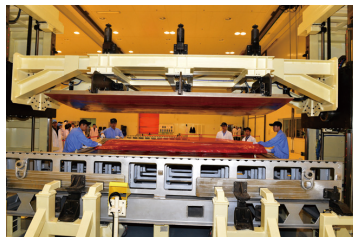
(g) 将零件成型模与翻转工装定位
