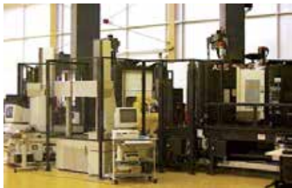
图8 罗罗公司叶片磨削单元 Fig.8 A grinding cell of blades in Rolls-Royce company
