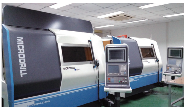
图1 皮秒级超短脉冲数控机床
