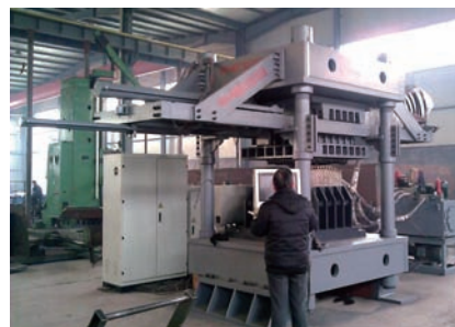
图2 500t船舶三维数控弯板机
