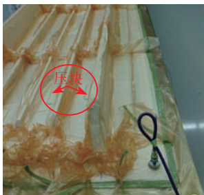
图19 梁腹板与水平加强筋共固化准备
