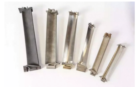
图9 Avio公司利用SEBM技术制造的TiAl涡轮叶片 Fig.9 TiAl turbo blade fabricated using SEBM technique by Avio
