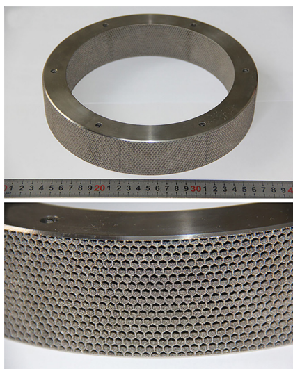
图10 利用SEBM技术制造的蜂窝结构 Ti-6Al-4V 油气分离转子
