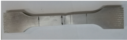
图18 试样拉伸断裂照片
