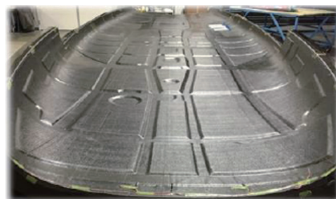
图3 SB-1型机复合材料应用案例: 先进复合材料机体结构 Fig.3 Composites application cases of SB-1: advanced composite airframe structure
