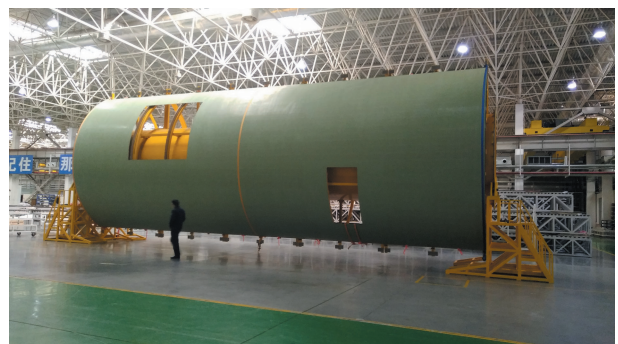
图13 壁板翻转工装
