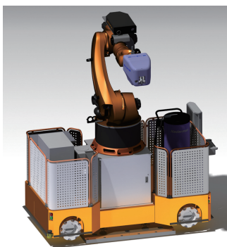
图4 单面紧固件机器人自动钻铆系统 Fig.4 Robot automatic riveting system for blind fastener
