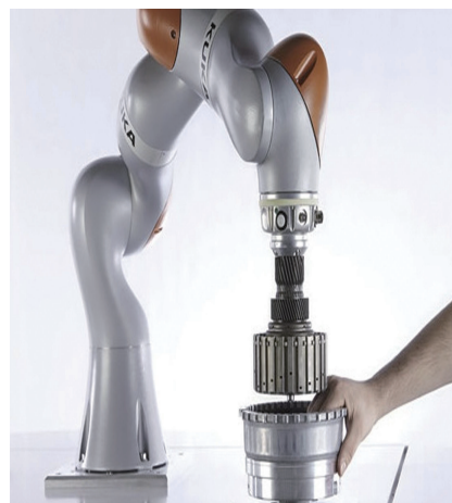
图13 对机器人的力和功率限制 Fig.13 Limitations on power and force of the robot
