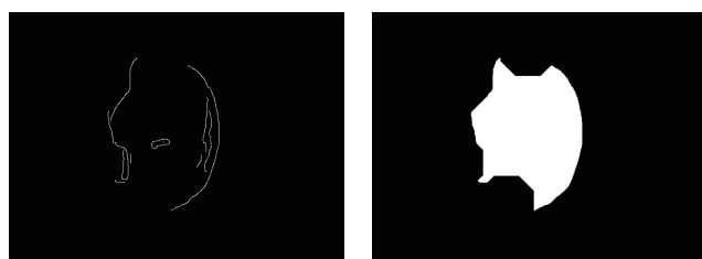
(a) 油污边缘检测图 (b) 用形态学闭运算得到的油污掩膜
